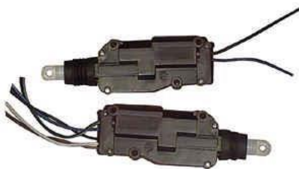
Рисунок 5.1 – Активатор (привод центрального замка автомобиля Saturn ms-200)
